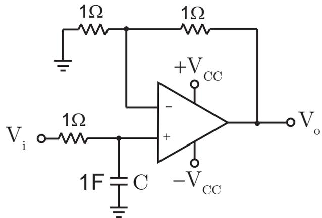
Considerando uma tensão contínua de entrada ( $V_i$ ) de  $2 \text{ V}$ , qual a tensão de saída ( $V_o$ ) do circuito?
