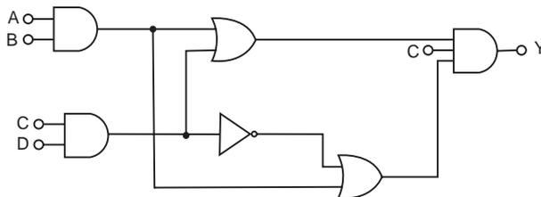
No circuito lógico, existem atrasos de propagação do sinal elétrico que resultam em atrasos para acionamento do alarme. A tabela a seguir apresenta os tempos de atraso medidos para cada porta lógica.
