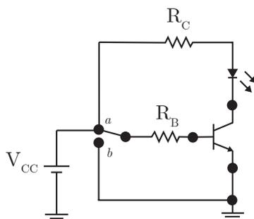
Com a chave na posição *a*, o LED acende e, na posição *b*, o LED apaga. O estudante utilizou um LED vermelho, que possui queda de tensão de 2 V e corrente de 10 mA em condição de funcionamento, além de um transistor com as seguintes características:
