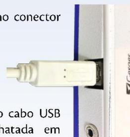
4. Ligue a ponta quadrada do cabo USB no a-blinX e a ponta achatada em qualquer **carregador ou fonte de 5V USB**.
