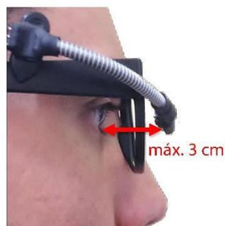
2. Curve o tubo metálico de maneira que o sensor fique bem de frente para a vista e a, no máximo, 3 cm de distância do olho. **Passo o fio por trás da orelha** para sustentá-lo.
