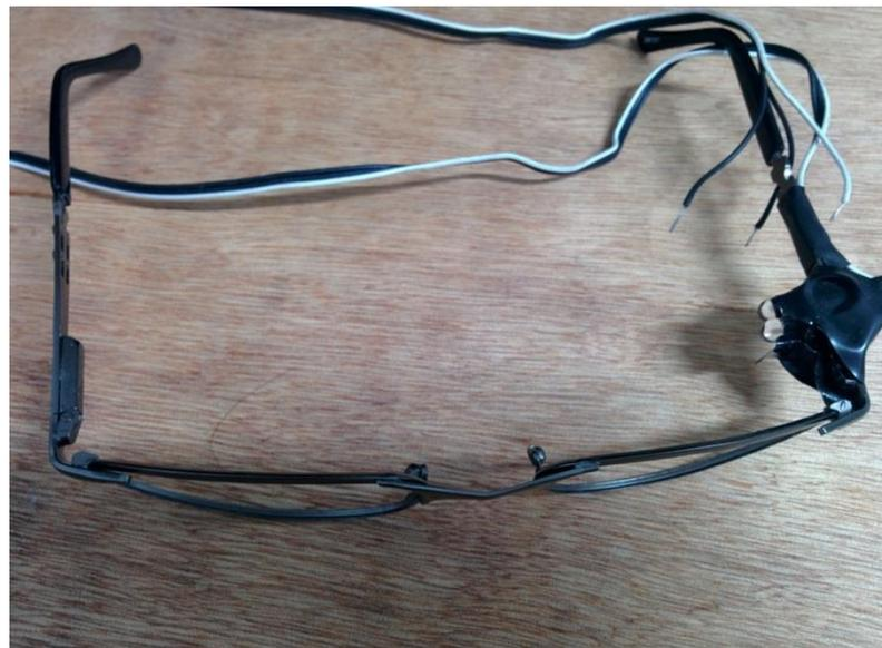
Figura 4 – Óculos com receptor fixado
