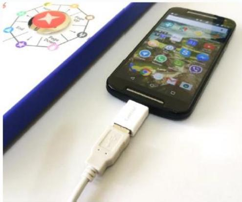
Conecte firmemente a ponta achatada do cabo do TiX à entrada USB Fêmea do seu adaptador USB OTG (não incluso).
