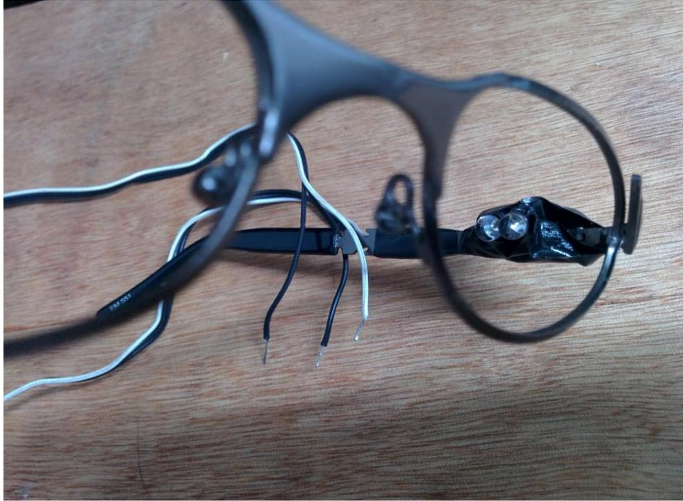
Figura 5 – Vista dos sensores fixados no óculos
